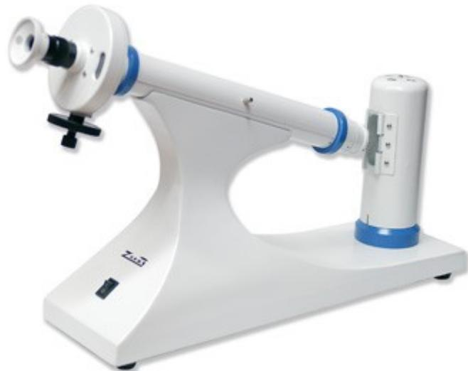
La rotación del plano de la luz polarizada por una sustancia ópticamente activa se detecta y se mide en un instrumento que se denomina “**polarímetro**”, que consta de: una fuente luminosa, un polarizador, un tubo para contener la muestra que se va a analizar y un segundo polarizador llamado analizador.
